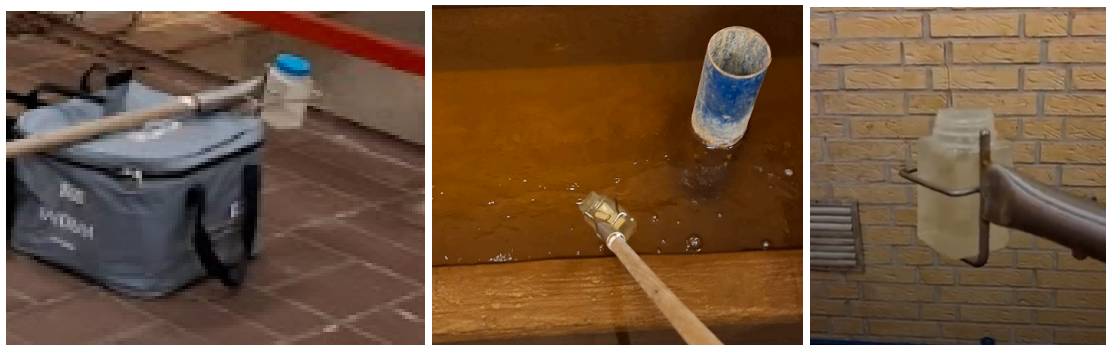
Figur 2: Udtagning af vandprøver fra "mellemrenden". Prøvetagningen foretages med en stang, hvorpå der er påmonteret et nyt 250 ml plastbæger.
