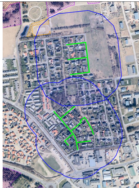
Figur 1: Etape 2 – Koralbanke Øst (øverst) og Fænøvej (nederst) inkl. beregnede sænkningstragte.
