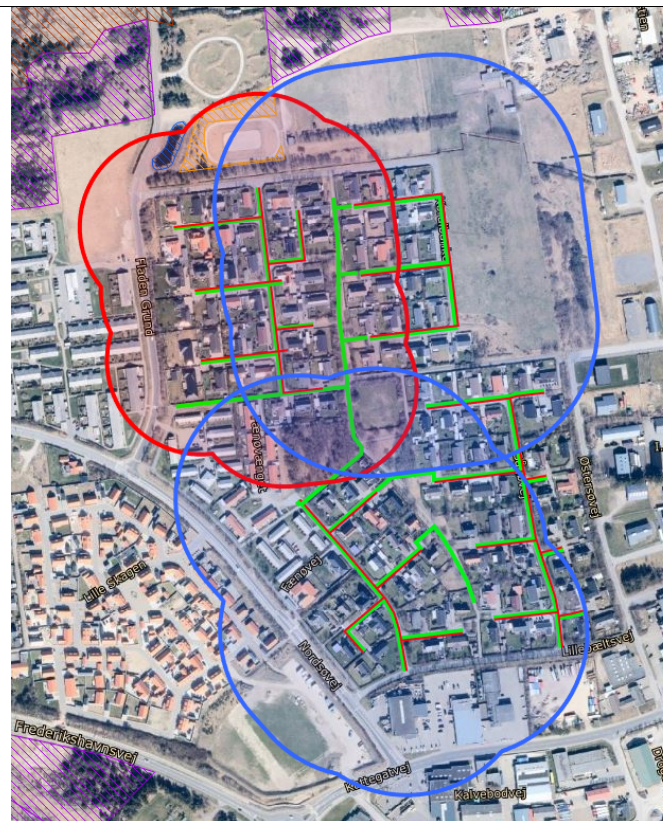
Figur: Det røde område er den beregnede sænkningstragt for etape 1's permanente drænsystem, mens de blå områder er de beregnede sænkningstragter for den midlertidige grundvandssænkning i de to områder i etape 2. Kanten af områderne indikerer op til 5 cm sænkning
