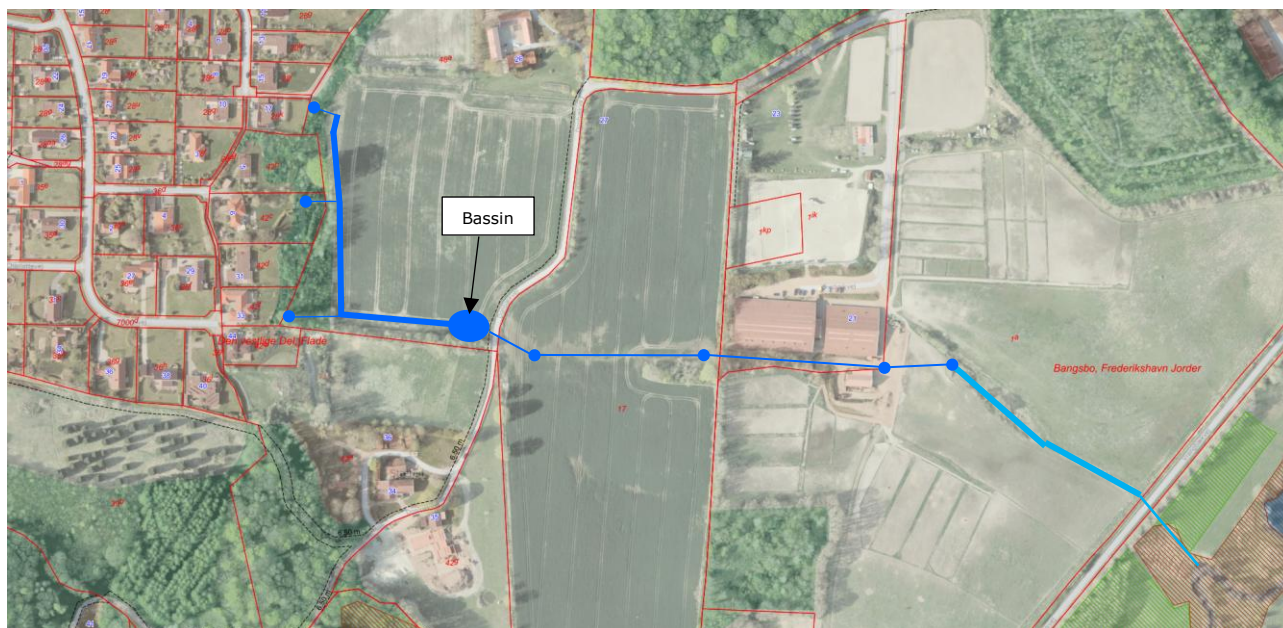
Figur 2: Skitsering af projektets omfang. Mørkeblå steger viser nyt vandløb, mens lyseblå viser eksisterende grøfter som genanvendes. Brønde er vist med cirkler. Rørlagte strækninger er vist som tynde streger, mens tykke streger viser åbne vandløb/grøfter.
