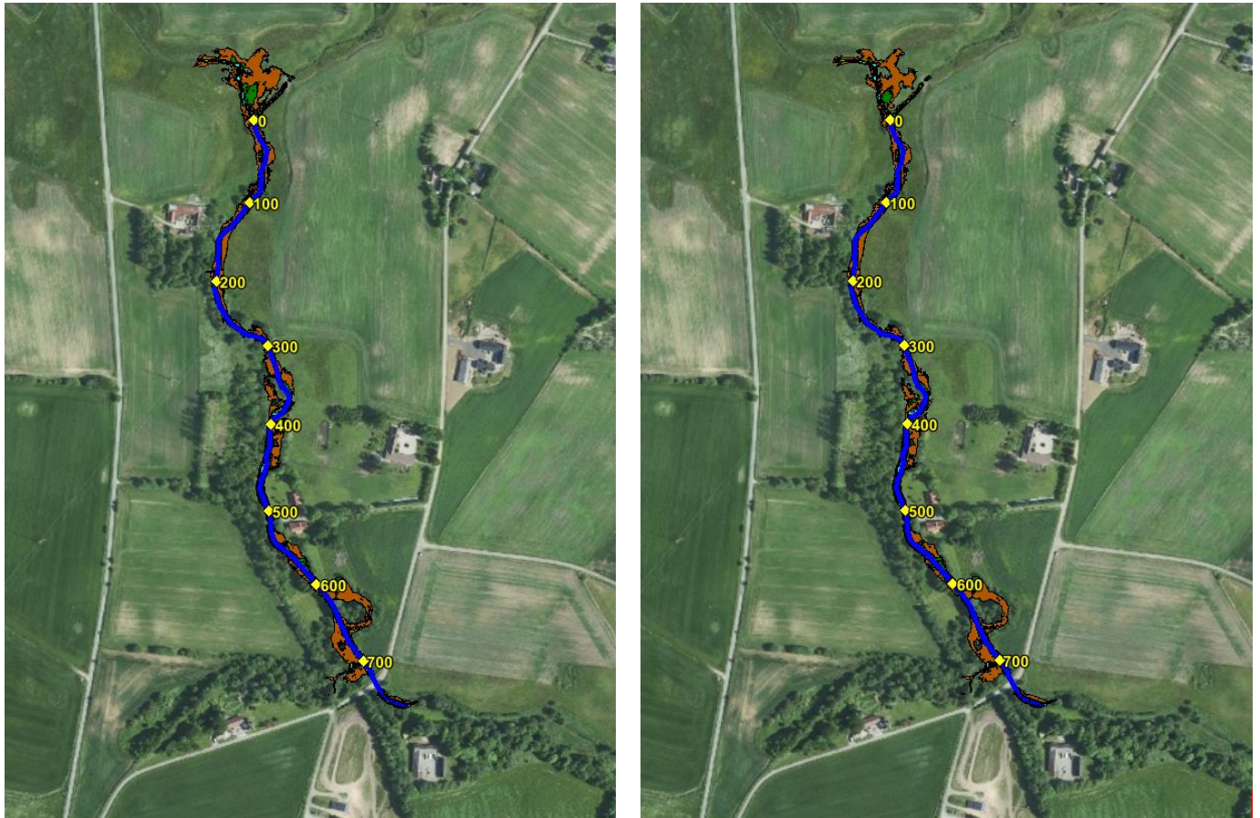
Fig. 7.2 Afvandingsstilstanden af de vandløbsnære arealer langs Sæsing Bæk, nedre del ved en vintermiddel afstrømning. Afvandingskortet til venstre viser den nuværende afvandingsstilstand (opmåling 2024) og afvandingskortet til højre viser det kommende krav til afvandingsstilstand (tabel 6.1). I tabel 7.1 er anført de enkelte afvandingsklasser.
