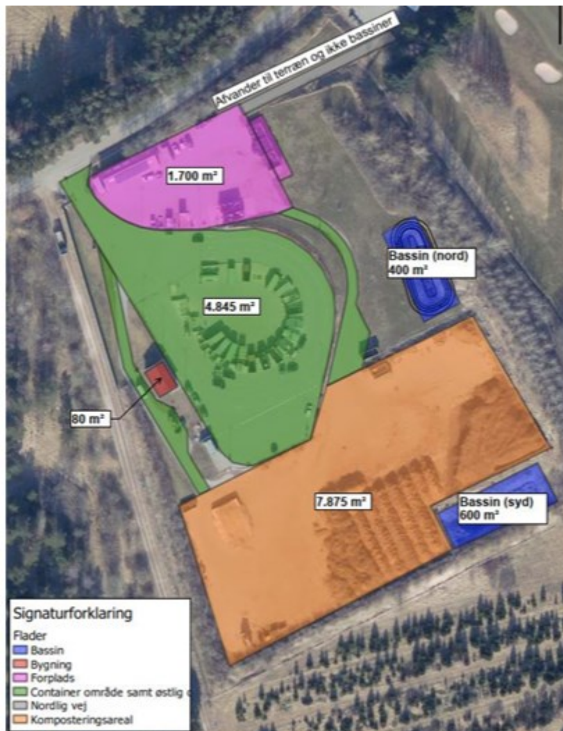
Flader som afleder til de to regnvandsbassiner. Det store orange areal – tidligere komposteringsareal - ledes til bassinet mod syd. De resterende arealer ledes til bassinet i nord.
