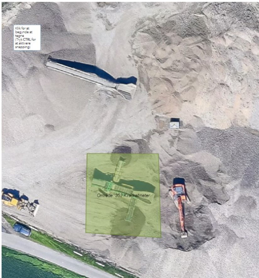
Figur 4: Mobilt solde/knuseanlæg (fra arbejderne på Ringsted-Femern Banen)
