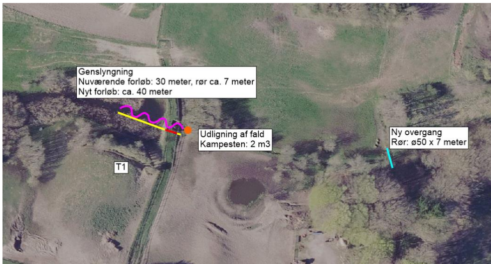
Restaurering ved strækning T1. Det nye, slyngede forløb er tegnet med lyserødt inden for den gule og røde strækning. Kampestenenes placering er markeret med orange og den nye overgang med lyseblå.
