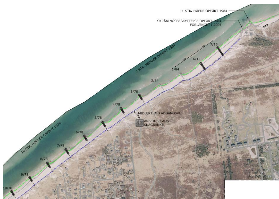
Figur 3: Oversigt inkl. navngivning af de eksisterende kystbeskyttelsesanlæg langs projektstrækningens nordlige halvdel
