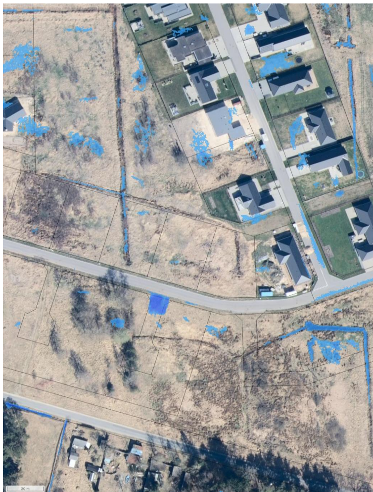
Figur 1 Skybrudskort over området ved en 2-årshændelse før (tv.) og efter (th.) udførslen. Vanddybder \geq 5 cm er markeret med blå inden udførslen og lilla efter udførslen.
