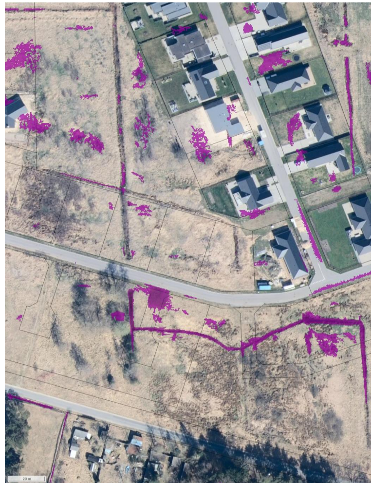
Figur 1 Skybrudskort over området ved en 2-årshændelse før (tv.) og efter (th.) udførslen. Vanddybder \geq 5 cm er markeret med blå inden udførslen og lilla efter udførslen.
