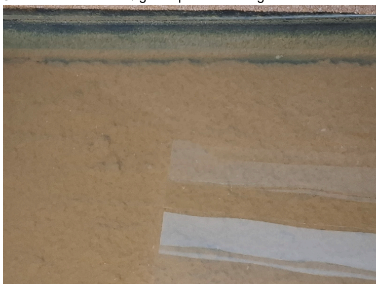
Figur 12: Flokke observeret på toppen af sandfilter- synligt større end før PAC doseringen. Foto før returskylning af Filter 1 fredag 06.06.25, ved afslutningen af forsøg IA.
