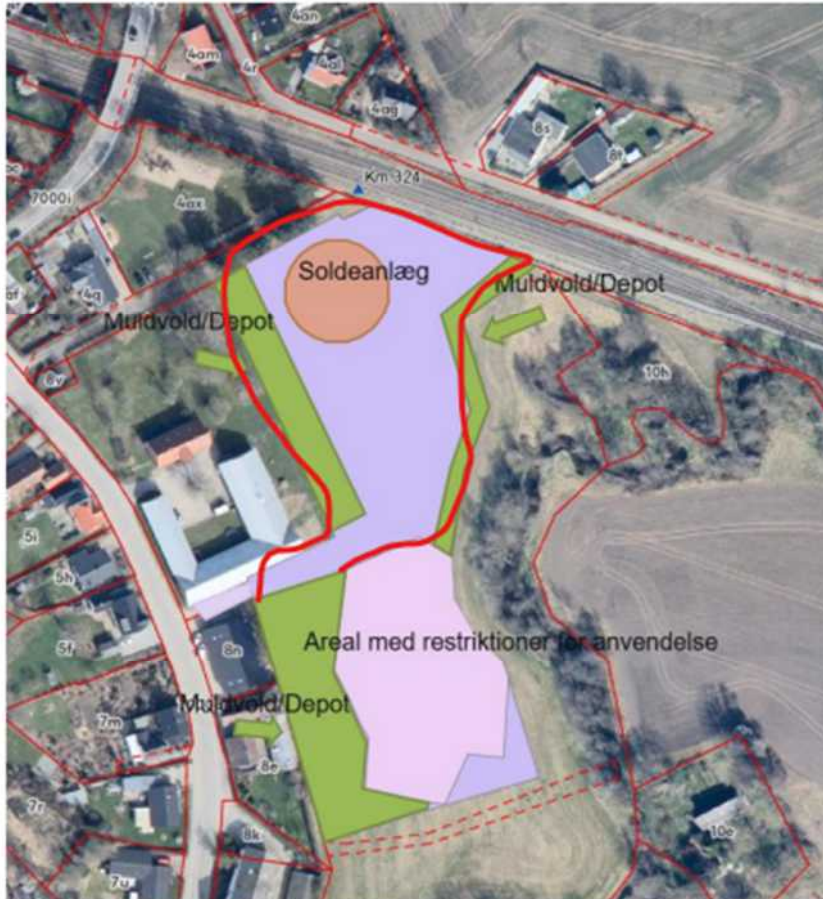
Figur 2: Indretning af byggeplads med placering af afrømmer muld i volde samt placering af solde-knuseanlæg
