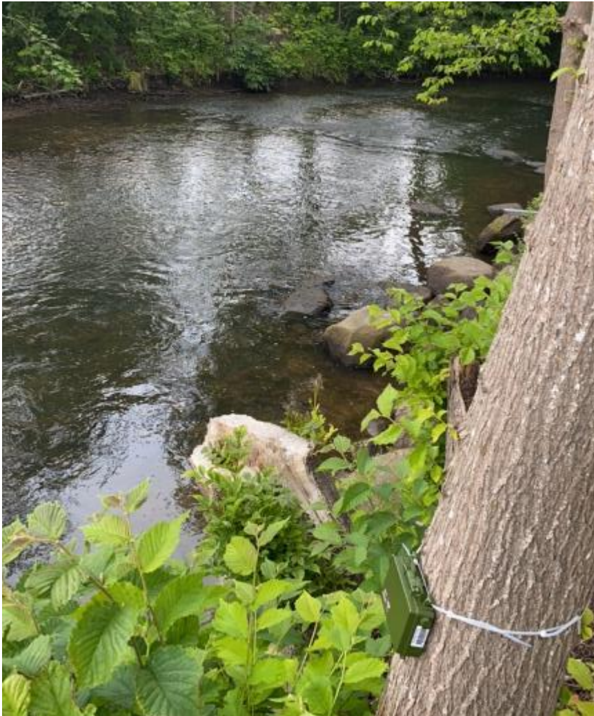
Figur 2 Fysisk opsætning af flagermusdetektor Song Meter Mini Bat 2 på projektet.
