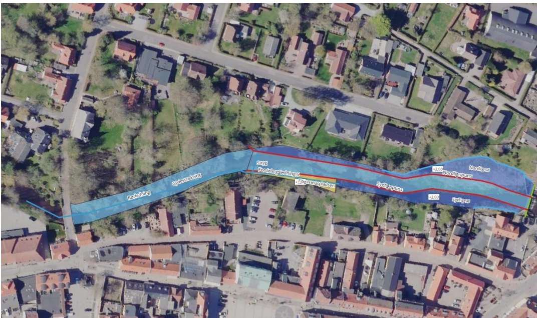
Figur 1-1 Konceptskitse for projektet. Rød angiver spunsvægge, gul angiver udvidelse af Flagermuspladsen.
