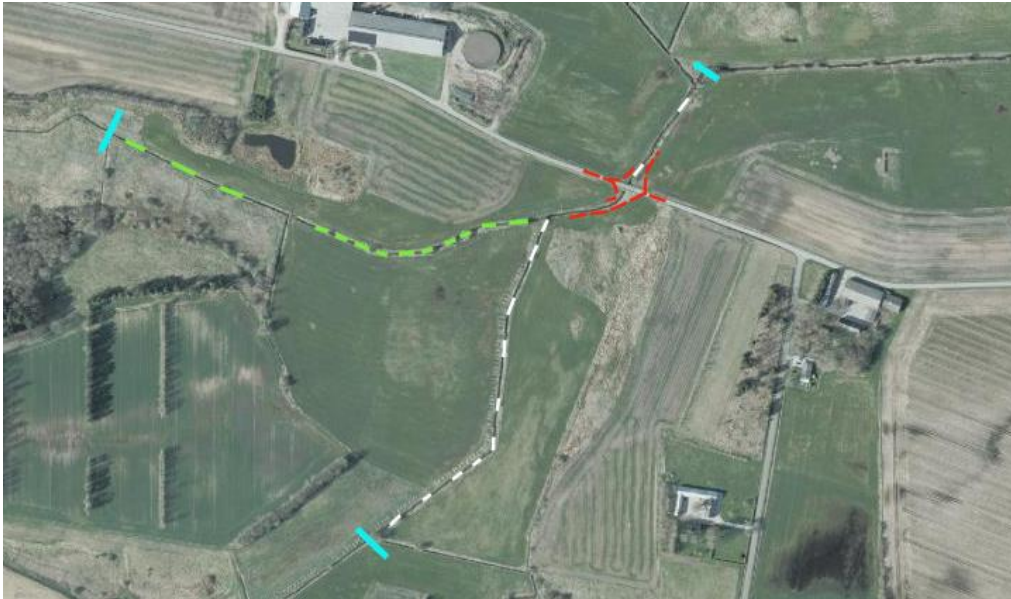
Figur 4: Område 3 (mellem de blå streger). De mulige adgangsveje er markerede med rød. Bundudskiftningerne er markerede med grøn. Udlægningen af gydegruset er markeret med hvid.
